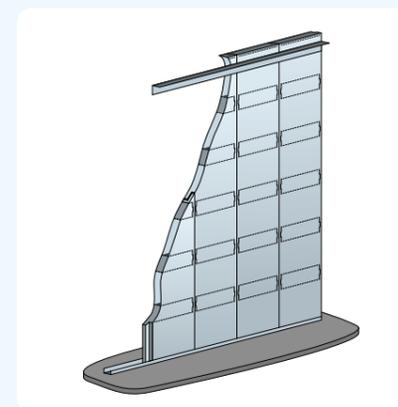
I pannelli blindati certificati antiproiettile vengono utilizzati per la realizzazione di locali blindati. L'intera struttura composta da pannelli è assemblata mediante saldatura. Le viti di fissaggio del basamento sono completamente nascoste, inaccessibili dopo il montaggio.
