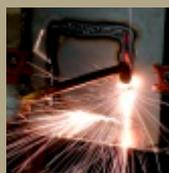
ProGuard è stata approvata da ECB•S Grado III secondo la Norma EN 1143-1 per la protezione contro l'effrazione. Per testare il livello di resistenza di ProGuard sono stati utilizzati una serie di strumenti, da quelli più semplici alle apparecchiature termiche ed elettriche più sofisticate.
